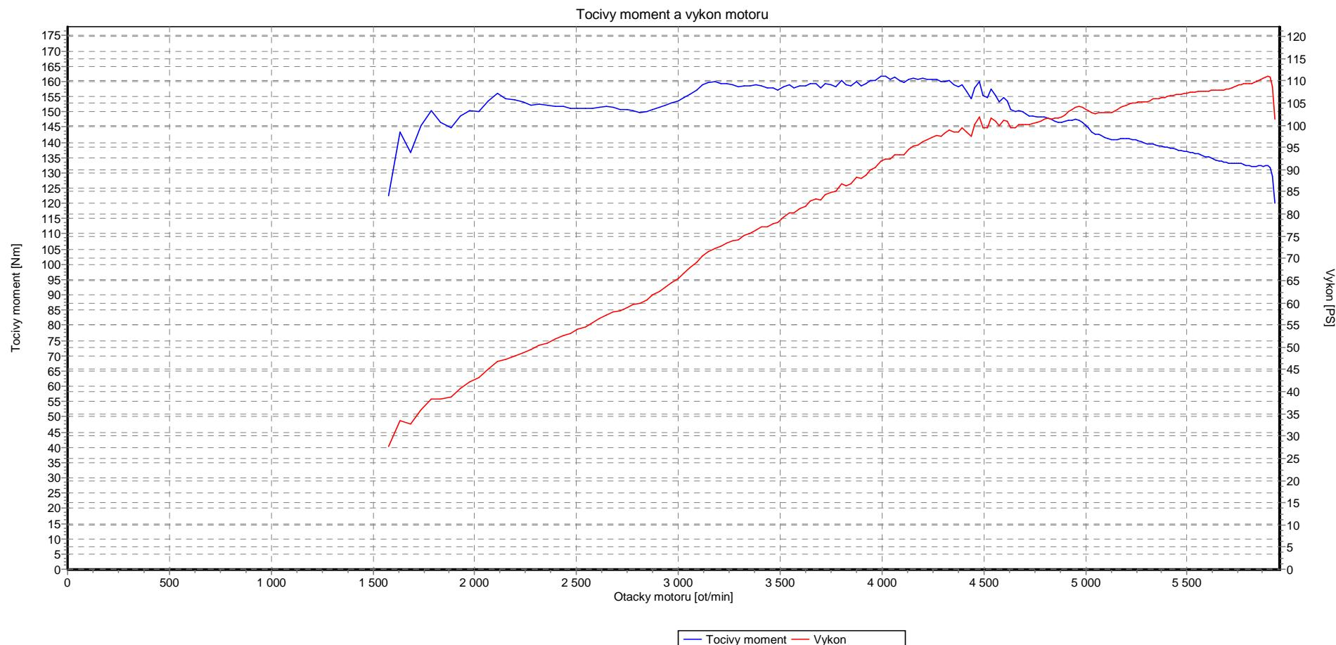
Maximalni tociiv moment 161,79 Nm pri 3992 ot/min, Maximalni vykon 111,1 PS pri 5897 ot/min, Vykon navysen o 11,2% podle ISO
